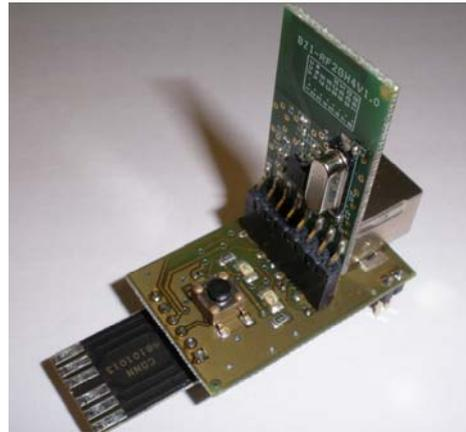
**Figura 10: Transceptor insertado en la placa USB**
