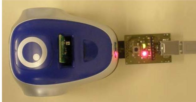
**Figura 25: Moway conectado a la placa USB**
