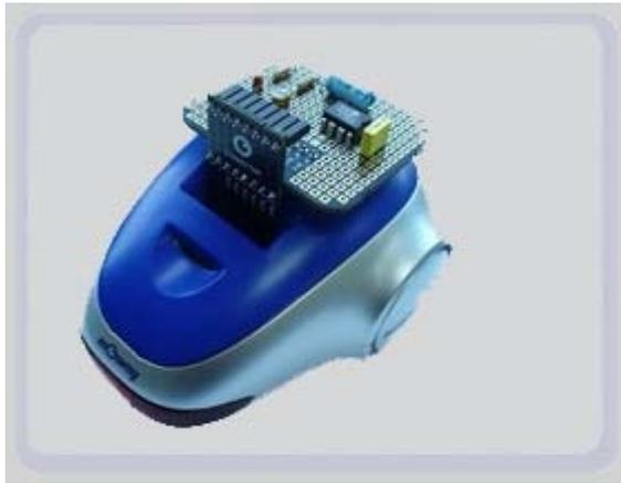
**Figura 133: Tarjeta de expansión**
