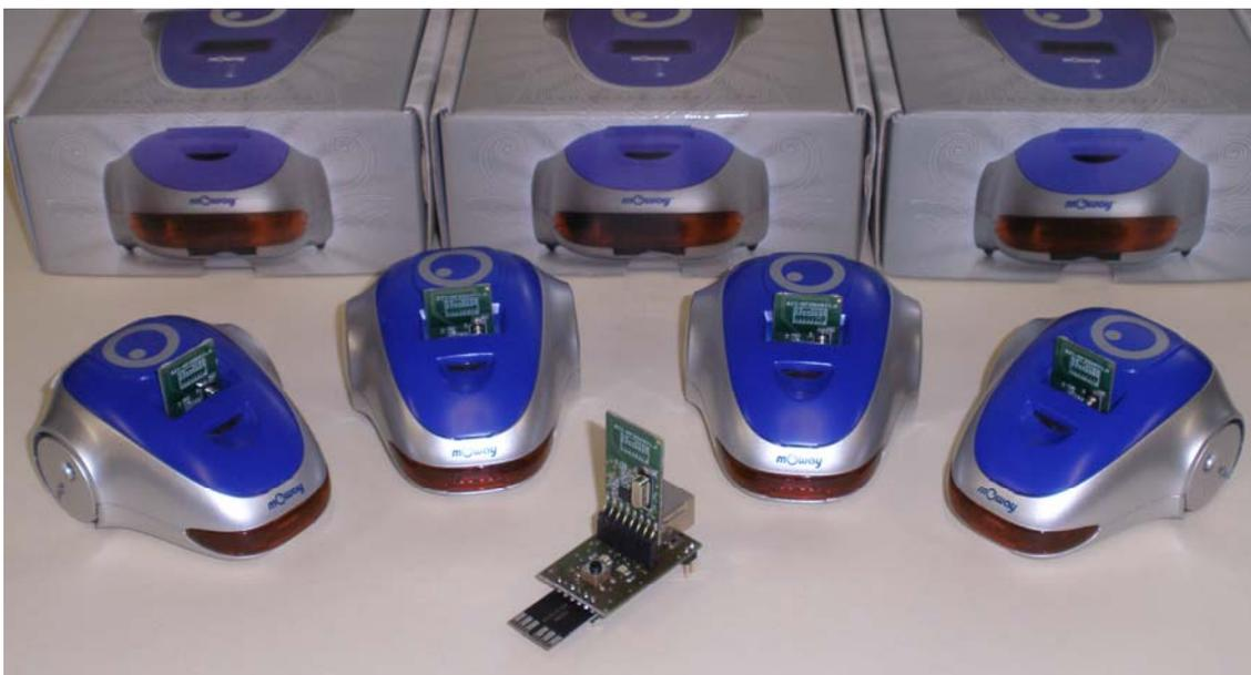
**Figura 1: Moways junto a una placa USB con transceptor BZI-RF2GH4**
